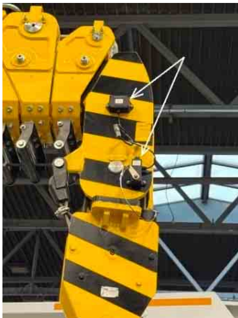
Рисунок 2.2 – Ограничитель перемотки каната
