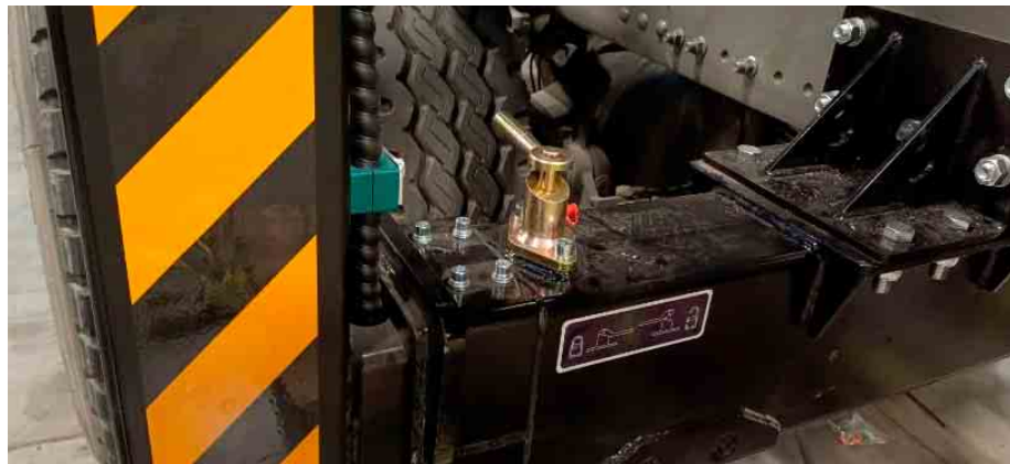
Рисунок 8.2 – Рычаг фиксатора задних выносных опор в положении «разблокировано»
