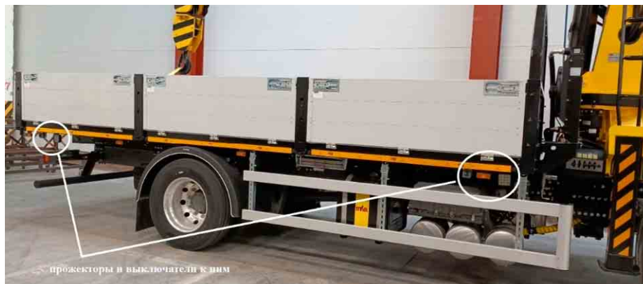
Рисунок 4.1 – Размещение прожекторов и выключателей к ним
