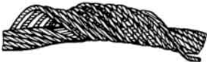
Рисунок Д.10 – Корзинообразная деформация
