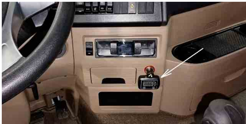
Рисунок 1.16 – Место установки счетчика моточасов
