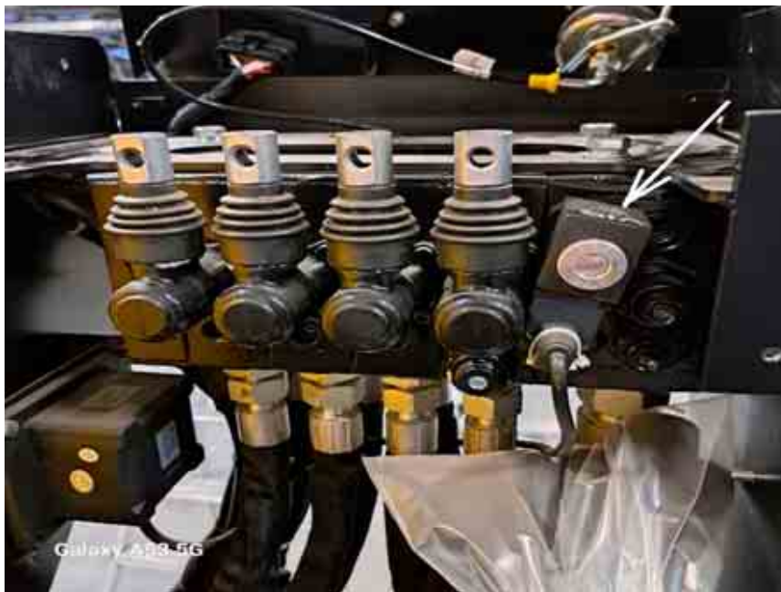
Рисунок 2.3 – Электромагнитный разгрузочный клапан
