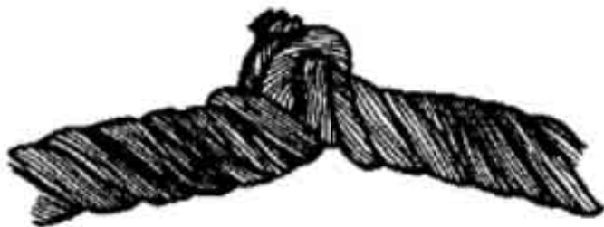
Рисунок Д.15 – Перекручивание каната
